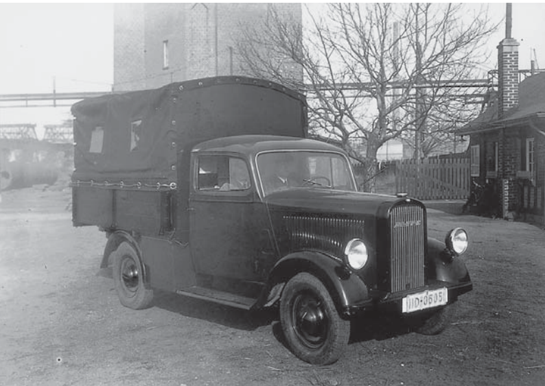
2 Mannschafts- und Schaumgerätewagen Opel Blitz 0,8 Tonnen Vorkriegsmodell. Mit diesem Fahrzeug wurden von der Entwicklungsabteilung der Hoechst AG verschiedene Schaumeinsätze vorgeführt.
