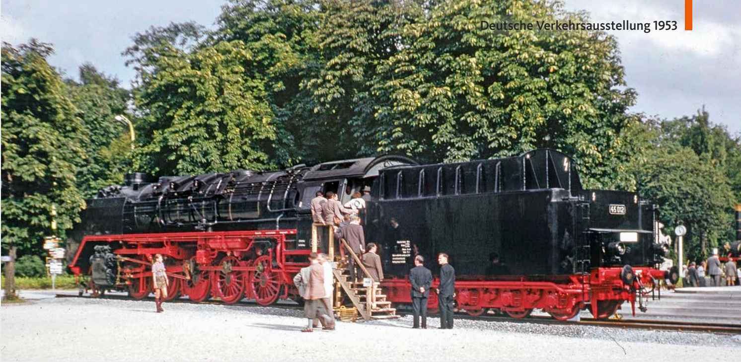
Wegen der erstmals bei einer deutschen Lokomotive eingebauten selbsttätigen Rostbeschickung der Bauart „Standard Stoker“ ist 45 012 auf der Verkehrsausstellung in München ausgestellt
