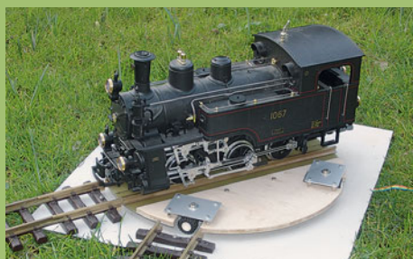
Gartenbahn-Drehscheibe mit Schrittmotorsteuerung
