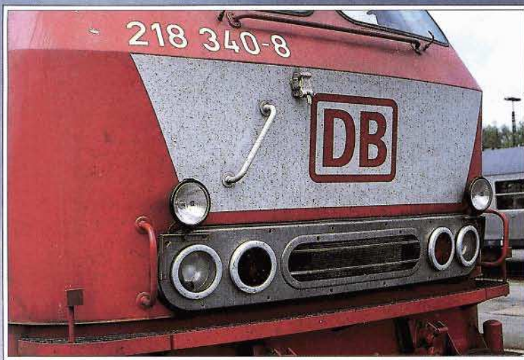
Bilder 3 bis 6: Momentaufnahmen, die zweierlei bestätigen: Die Lokomotiven der V 160-Familie zählen zu den optisch gelungensten Fahrzeugen der Deutschen Bahn und weisen relativ moderne und geräumige Arbeitsbedingungen für den Lokführer auf. Links die mit Zusatzscheinwerfern ausgerüstete 218 340 des Bw Mühldorf – bereits mit neuem DB-Logo. Abb.: A. Ritz (links), M. Werning (großes Bild und rechts unten), J. Seyferth (links unten)
