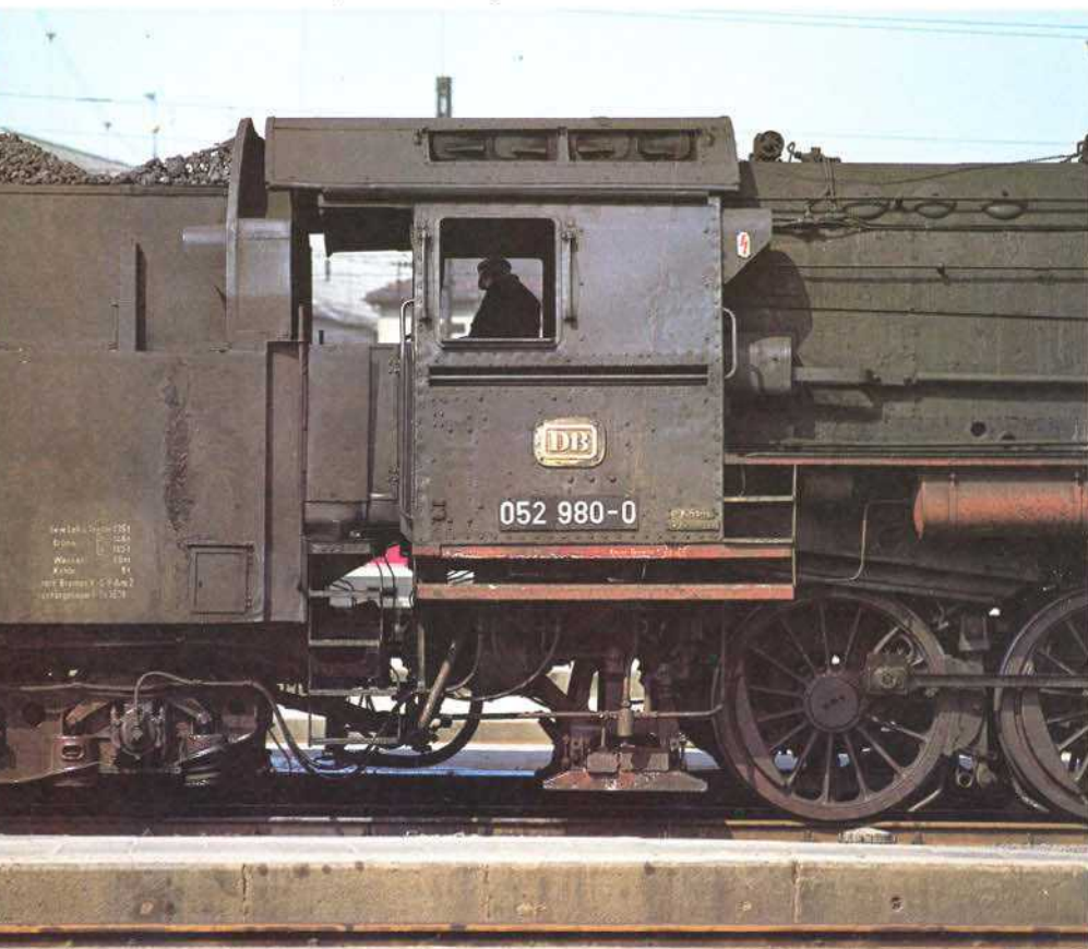
Bild 10: Als ehemalige UK-Lokomotive besaß die 052 980 des Bw Nürnberg Rbf kein vorderes Führerstandsfenster. Das Foto entstand im Oktober 1969 im Hauptbahnhof Nürnberg. Foto: J. Nelkenbrecher
