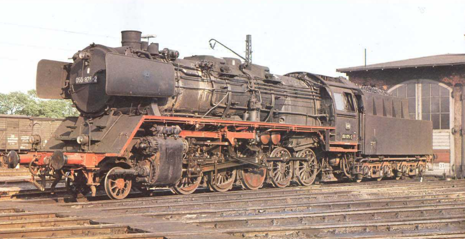
Bild 13: Bis zum Ende ihrer Dienstzeit behielt die 050 975 vom Bw Nürnberg Rbf ihre Frontschürze. Die 1941 von Krupp gelieferte Maschine hatte durch eine Verfügung des BZA Minden eine Riggbach-Gegendruckbremse erhalten.
