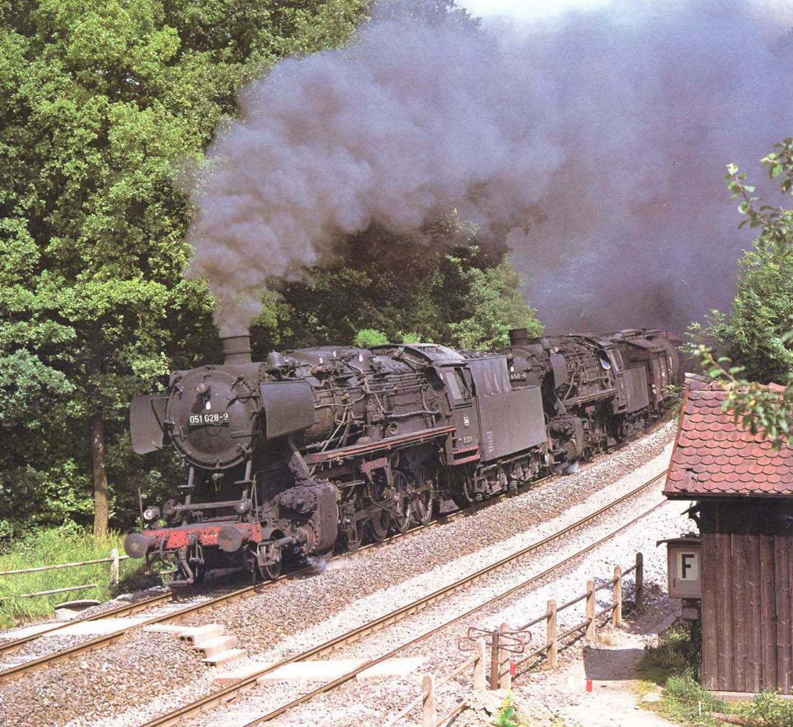
Bild 1: Mehrere Rampenabschnitte auf der Strecke Crailsheim – Heilbronn erforderten zur Dampflokzeit zwei Lokomotiven zur Führung schwerer Güterzüge. Anfang der siebziger Jahre kamen als Vorspannlokomotiven meist Lokomotiven der Baureihe 050 zum Einsatz, manchmal aber auch eine Crailsheimer 023. Bei Gailenkirchen mühen sich die 050 450 und die Vorspannlokomotive 051 028 mit dem Dg 6750 von Crailsheim nach Heilbronn über einen dieser Rampenabschnitte (3. Juli 1971). Foto: J. Nelkenbrecher
