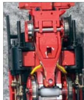
Zwei zusätzliche Stromabnehmerpunkte schuf W. Brauers an seiner Roco-52.
