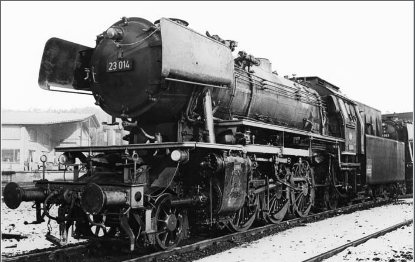
23 014 Anfang der 60er-Jahre im Bw Bestwig. Offensichtlich handelt es sich hier um einen Schadfall, denn der Lok fehlt die Speisepumpe. Helmut Säuberlich, seinerzeit Direktionsfotograf der Eisenbahndirektion Wuppertal und selbst Modellbahner, bemerkt auf der Rückseite seines Abzuges: „23 014, Vorbild Märklin-Modell“.
