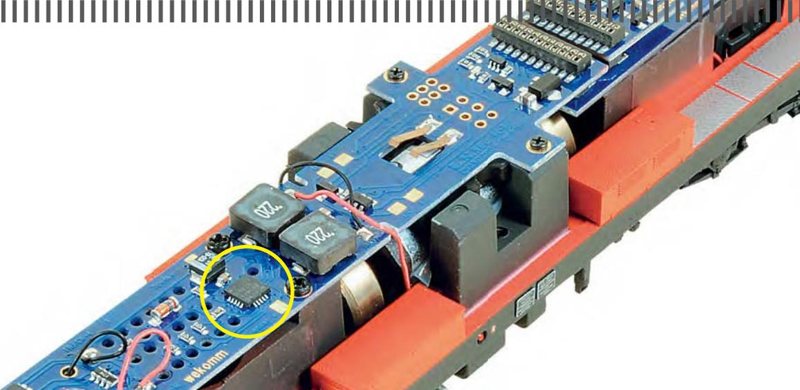
Schweizer dieselelektrische Lok der Reihe BM 6/6 von L.S.Models mit „intelligenter“ Lokplatine. Der Mikroprozessor auf der Lokplatine (gelber Kreis) steuert die komplexe Signalbildarstellung der SBB-Lok.
