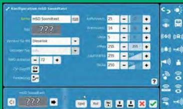
Märklins Sounddecoder mSD werden ab Werk mit Standard-Geräuschen für eine Dampf-, eine Diesel- oder eine Ellok geliefert. Wem diese Auswahl nicht ausreicht, kann auf der Märklin-Internetseite aus einer wachsenden Zahl lokspezifischer Sounddateien wählen und diese dann mit der CS2 auf den eigenen mSD aufspielen.
