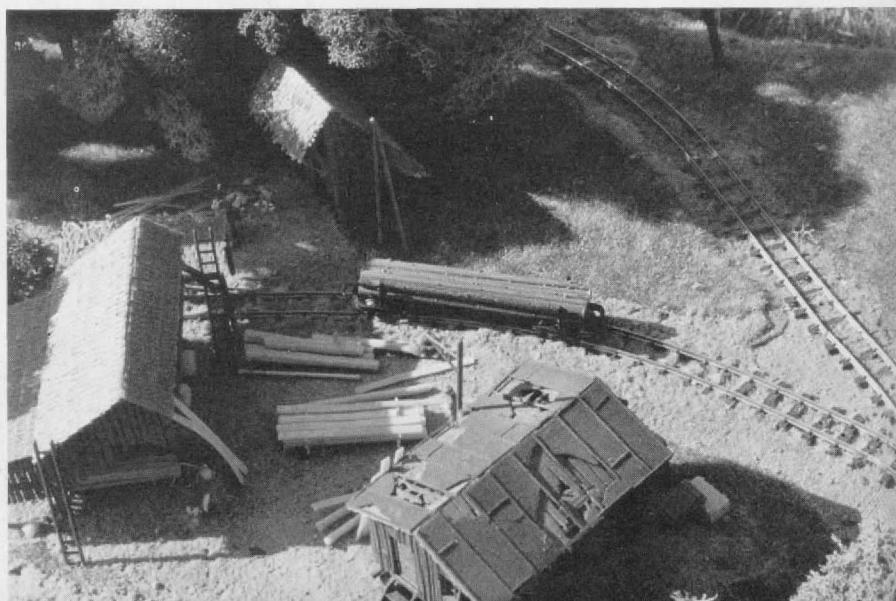
Abb. 1. Auf dem Anschlußgleis des Holzlagers stehen zwei Drehschemelwagen zum Langholztransport.
