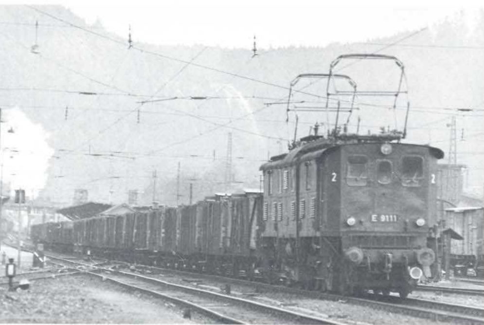
Bild 13: Im Januar 1962 hat sich die E 91 11 in Probstzella (DDR) als Schublokomotive an den Zugschluß eines Güterzuges nach Pressig-Rothenkirchen gesetzt, um ihn über die Nordrampe der Frankenwaldbahn zu schieben.
