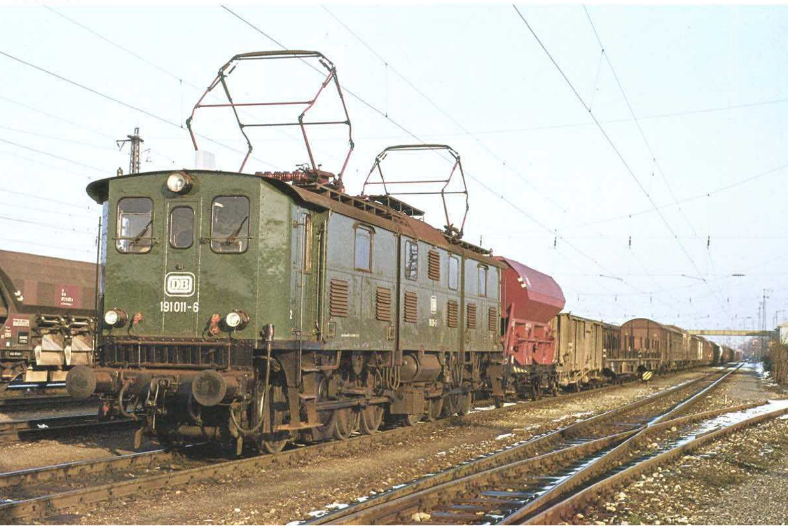
Bild 11: Die bei den Maschinen E 91 01 bis 20 ursprünglich vorhandenen Stirnwandtüren wurden später verschlossen, so auch bei der E 91 11, die 1968 die Betriebsnummer 191 011 erhielt. Die Aufnahme entstand im März 1975.
