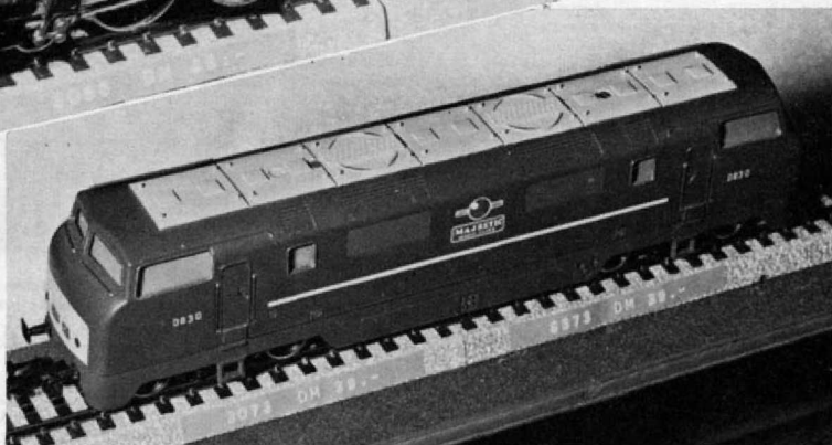
Abb. 146. „Majestic“ heißt dieses Modell einer britischen B'B'-Diesellok der „Warship Class“, das (vollkommen vorbildgerecht) in Fahrgestell und Aufbauten der bekannten V 200 „nachempfunden“ wurde (Preis: 39,- DM).
