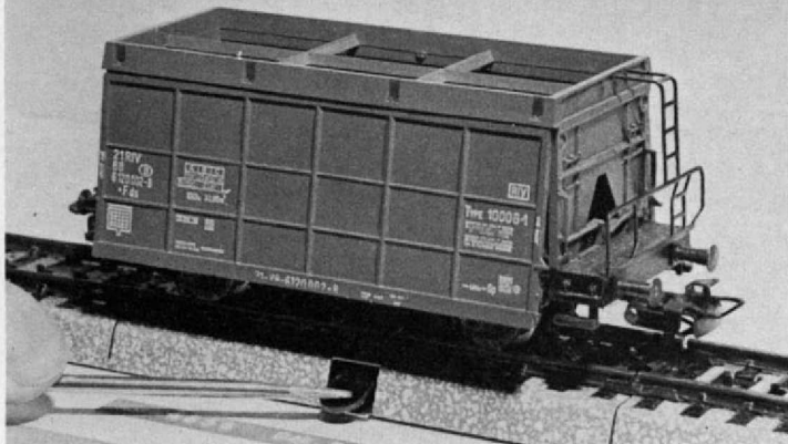
Abb. 149. Interessant von Form und Funktion her: der neue Selbstentlader vom Typ 1000 G-1 der SNCB. Die Seitenwände des Modells können von unten her mittels des Entkuppungs-gleisstückes 5112 seitwärts in einem Winkel von etwa 10° aufgeklappt werden. Ein gut detailliertes und sauber beschriftetes Modell. Preis: 7,50 DM.
