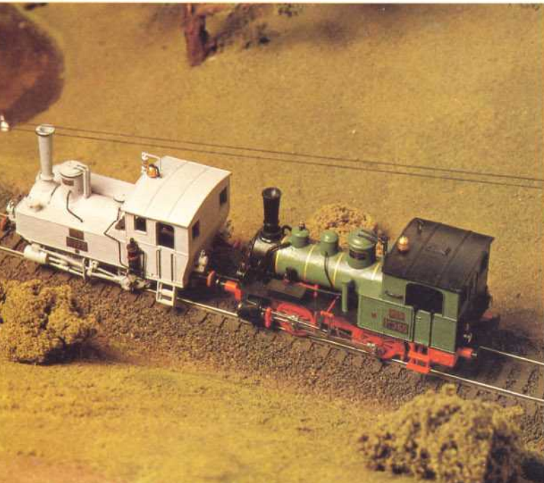
Bild 6: Auf dieser Aufnahme erkennt man sehr gut die Bauartunterschiede der Gattungen Ib (links) und Ic (rechts) der Badischen Staatseisenbahnen.
