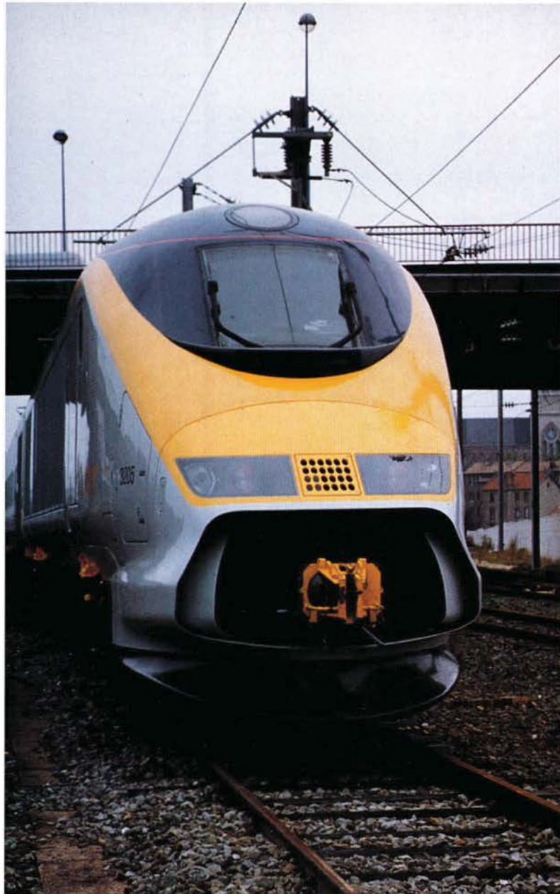
Auf dem Festland mit 300 km/h unterwegs, auf der Insel mit Energieübertragung durch Stromschienen auf 112 km/h beschränkt: Der Eurostar, der demnächst Paris mit London durch den Ärmelkanaltunnel verbindet.
