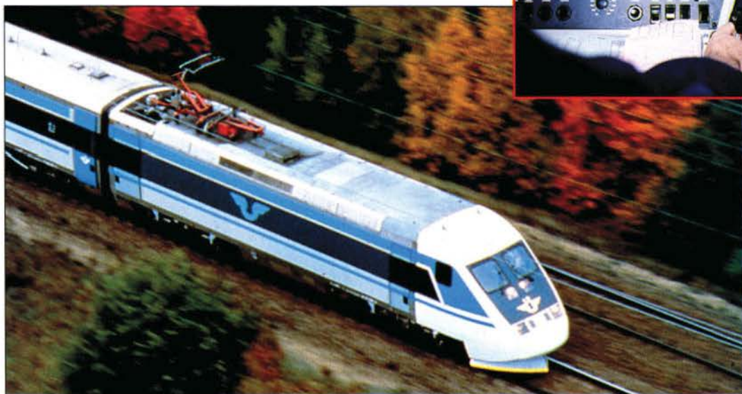
In Schweden fährt der X 2000 auf Strecken, die für 160 km/h ausgebaut sind, dank seiner Neigetechnik 220 km/h, auf unserem Nebenbild etwa 50 Kilometer vor Stockholm mit Tempo 192.
