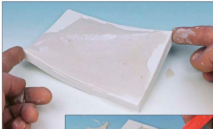
Sofort nach dem Eingießen sollte man die Form an den Ecken anheben und wieder zurückschnellen lassen. Damit werden eingeschlossene Luftblasen gelöst.
