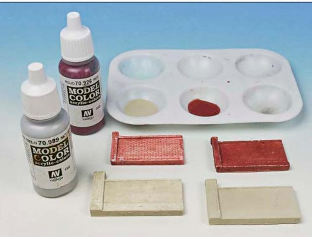
Links: Die Abgüsse aus Gips auf der rechten Seite saugen die Farbe deutlich stärker auf. Bei den Abgüssen aus KerafloTT wirkt die Oberfläche lange nicht so homogen, da die Farbe wegen der höheren Dichte des keramischen Materials nicht so tief eindringt.
