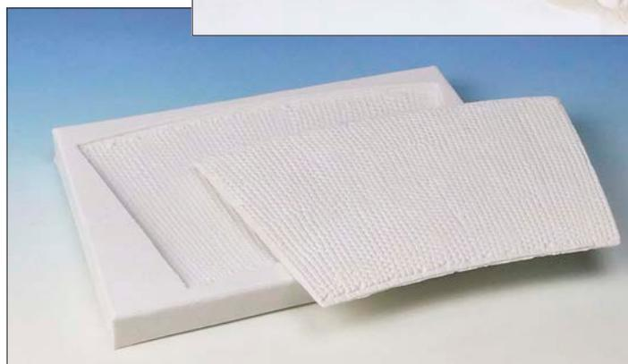
Nach gut 20 Minuten ist frischer Gips so weit ausgehärtet, dass die Abgüsse vorsichtig aus der Form entnommen werden können. Sie müssen nun auf einer ebenen Fläche weiter gut trocknen.
