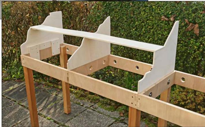
Auf den Spanten liegen zunächst die Gleistrassen auf. Der Raum zwischen den Spanten und den Trassenbrettern wird mit Aluminiumgewebe verkleidet.
