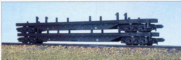
Zweierpack Wechselfahrgestelle von Arnold mit Kurzkupplungskinematik zum Umrüsten älterer Fahrzeuge der Transwaggon-Familie.
