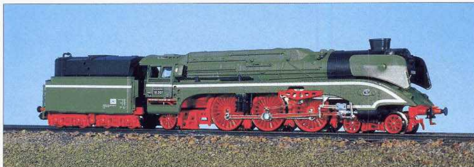
Arnolds 18 201 jetzt mit Öleinfüllstutzen am Tender und zwei Indusi-Magneten.
