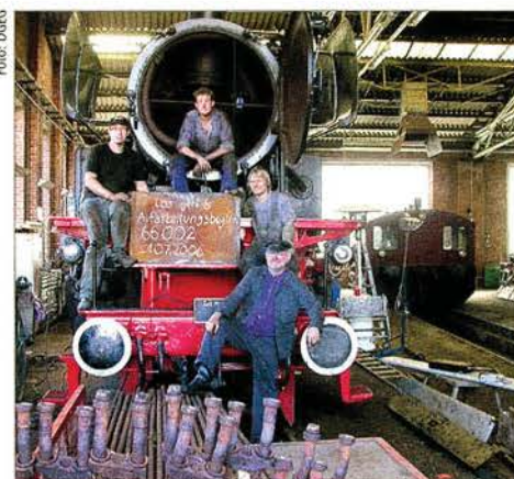
Mitarbeiter des DfEG-Eisenbahnmuseums Bochum-Dahlhausen haben damit begonnen, den Kessel der 66 002 für die innere Untersuchung vorzubereiten.
