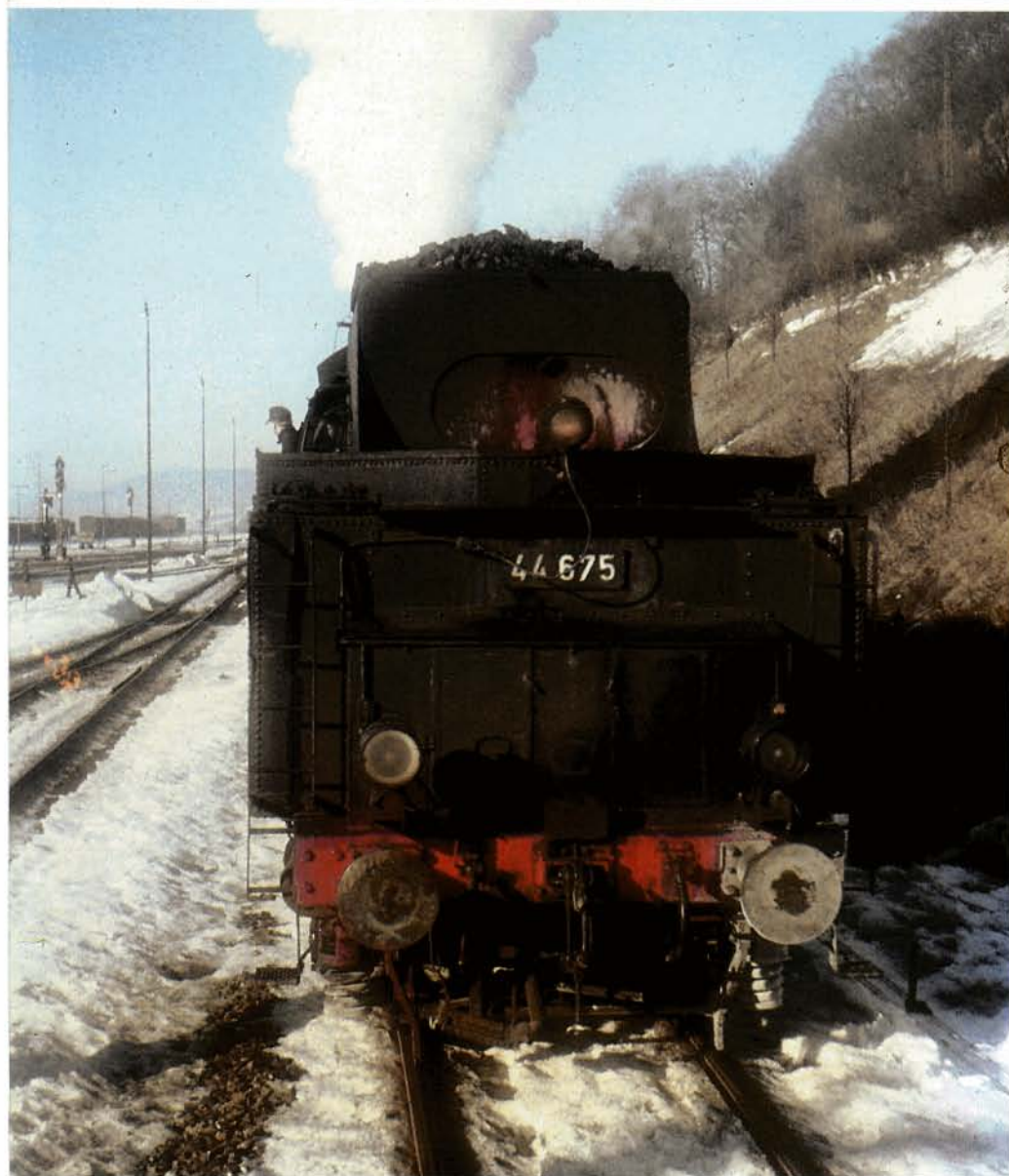
Bild 11: Der Tender 2'2' T 32 in neuerer Bauart war hier mit der 44 675 gekuppelt. Die Aufnahme entstand im Februar 1963 in Altenbeken.
