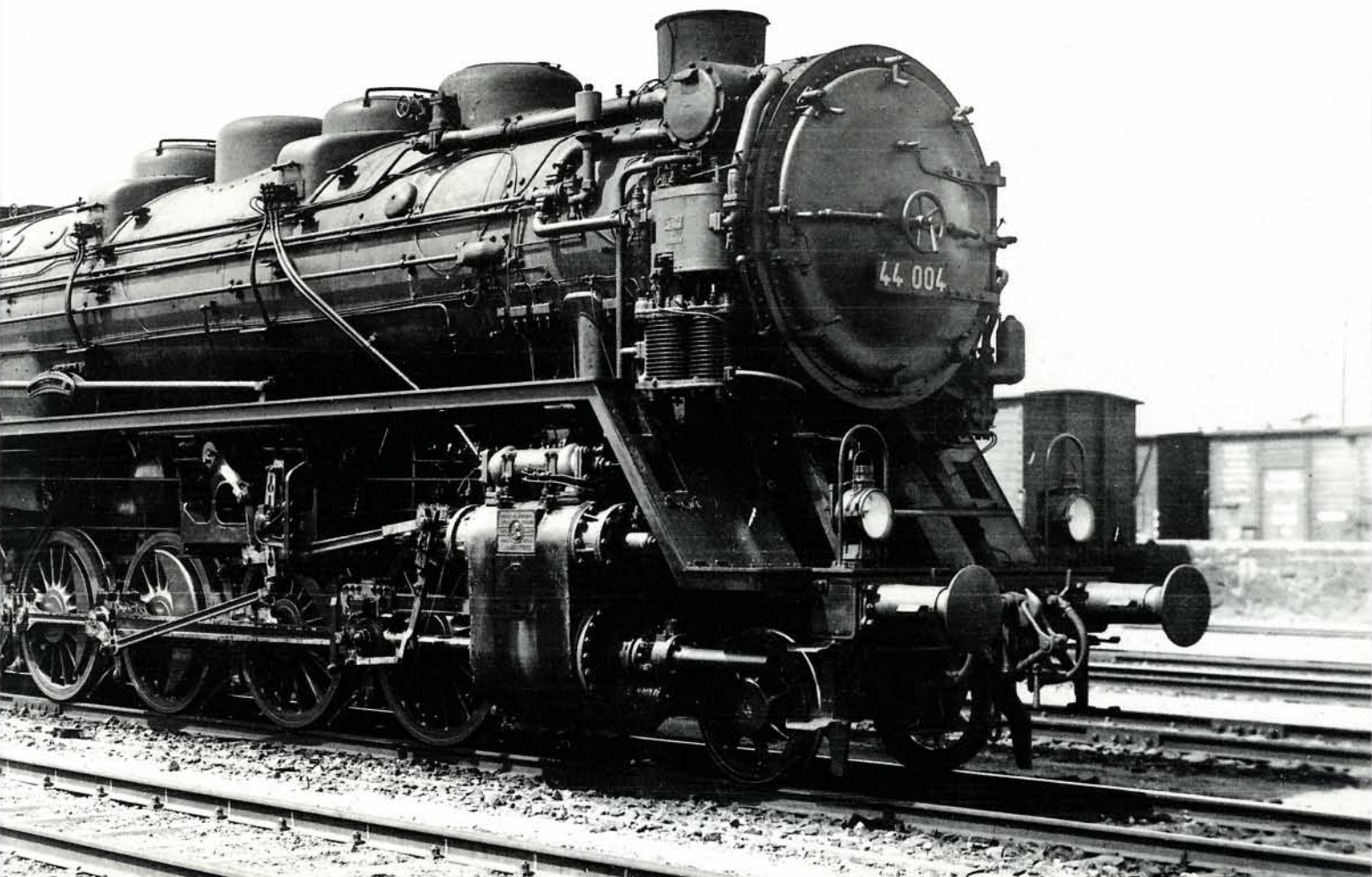
Bild 6: Eine von Schwartzkopf gelieferte Maschine: Die Baumusterlokomotive 44 004 war mit dem genieteten Tender 2'2" T 32 alter Ausführung gekuppelt.
