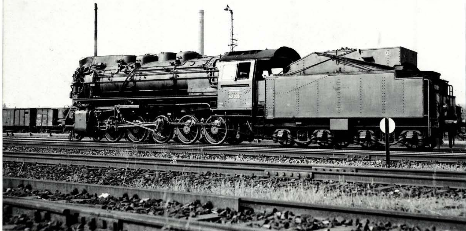
Bild 7: Die Lokomotiven der Baureihe 43 bekamen nur vereinzelt die großen Windleitbleche der Baureihe 01. Wie hier bei der 43 035 wurden verschiedene Formen von Windleitblechen erprobt. Foto: Dr. Feißel, Sammlung Dr. Scheingraber
