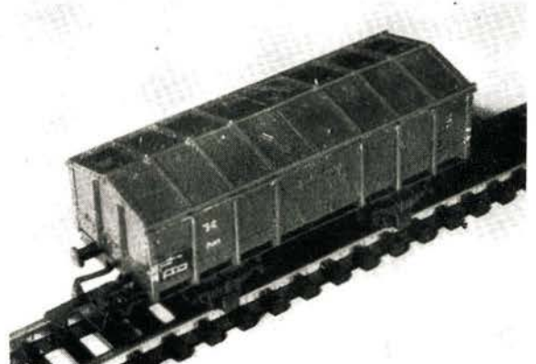
Bild 2 Aus einem O-Wagen wurde ein Klappdeckelwagen gebaut
