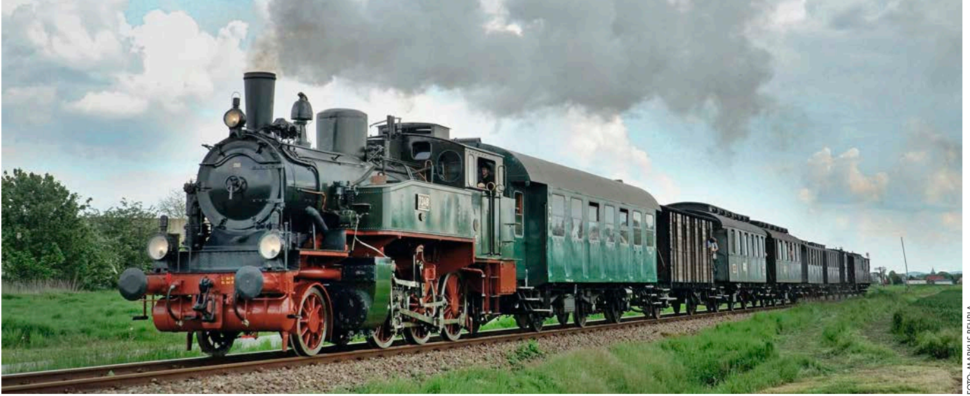
■ Die offizielle Einweihungsfahrt der T9.3 7348 Kattowitz der Museumseisenbahn Minden fand am 14. Mai 23 statt. Die 2004 in Polen erworbene Maschine wurde durch die Mindener Museumseisenbahn bei der Malowa in Nenndorf aus einer Dampfspeicherlok neu aufgebaut. Hier ist die preußische Dampflokomotive mit dem Museumszug bei Hartum auf der Mindener Kreisbahn unterwegs von Minden Oberstadt nach Hille.
