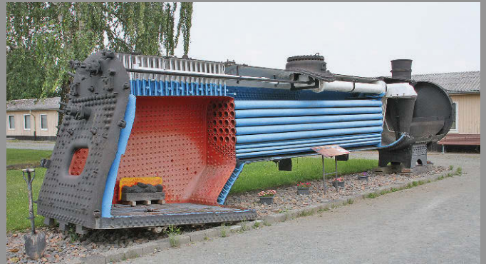
Sehr lehrreich wirkt dieser aufgeschnittene Dampflokomotivkessel. Die wasserumspülten Bereiche sind hellblau gestrichen, während die vom Feuer berührten Flächen rot sind. Dies gibt dem Besucher Aufschluss über Dimension und Funktion eines Kessels.
