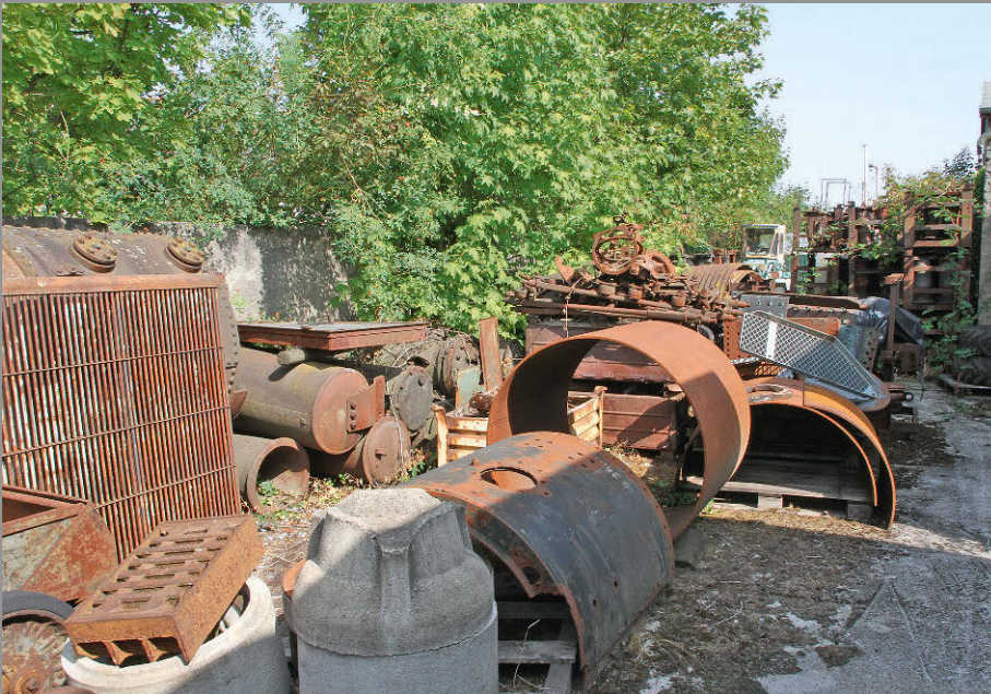
In den hinteren Ecken, die aus Gründen des Unfallschutzes für Museumsbesucher in der Regel nicht zugänglich sind, lagern allerlei Lokomotivbauteile (unter anderem Vorwärmer und Kesselbleche), die alle mehr oder weniger mit Rost überzogen sind. Ein nachbildenswertes Eldorado für Alterungsfetischisten ...
