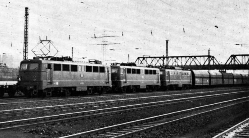
Abb. 1. Nicht nur Doppel-, sondern Dreifachtraktion mit drei Maschinen der BR 140 zeigt diese Aufnahme: eine 4000 t-Erz-Leerzug der DB im Bahnhof Wiesbaden-Ost. Sobald ein derartiger Zug in gleicher Formation jedoch von „Dampf-Kollegen“ übernommen wird, heißt es nicht mehr Dreifach- bzw. Doppeltraktion, sondern . . . Vorspann (s. a. Abb. 3). (Foto: Roland Hackl, Wiesbaden)
