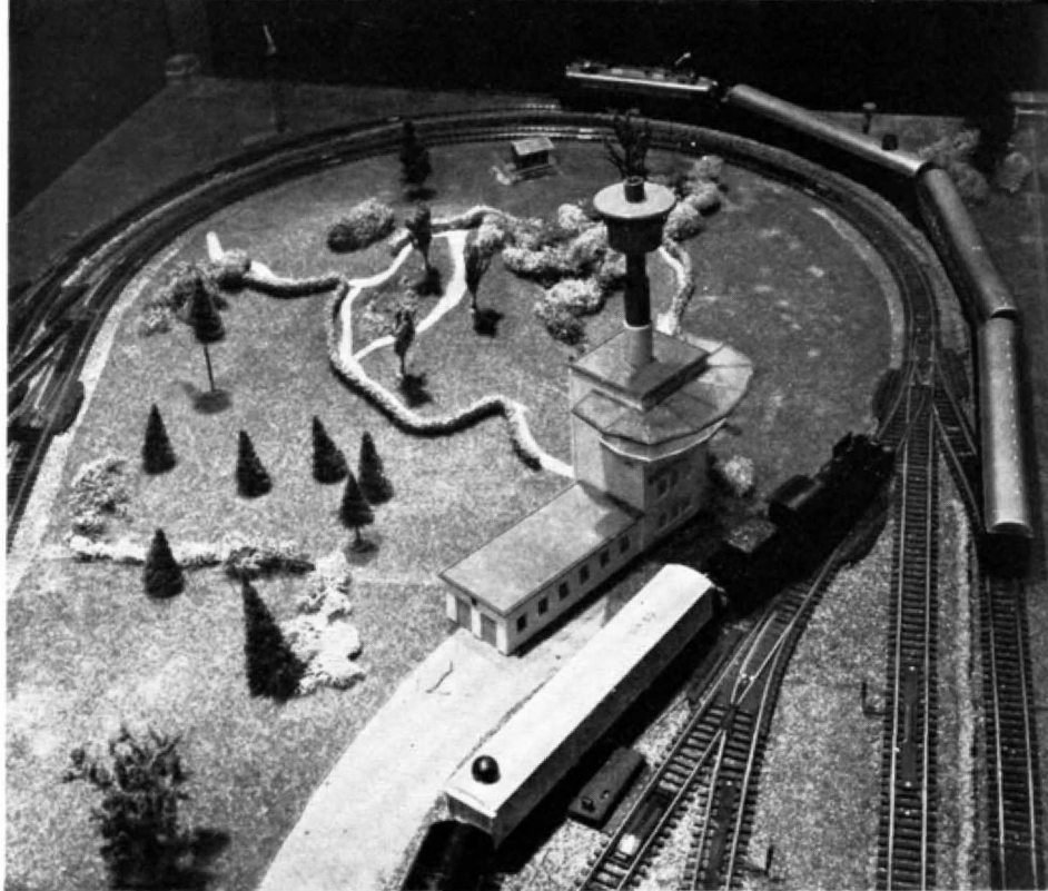
Abb. 1. Die H0-Anlage auf dem Siemens-Messestand. In dem Turm über dem Stellwerk sind die Infrarot-Sendediolen untergebracht; auf dem Dach des jeweils ersten Wagens ist das Gehäuse für die Empfängerdiolen zu erkennen. Die Schaltung ist ebenfalls in diesem Wagen untergebracht. Nach Angaben von Siemens ist es jedoch möglich, die Empfängerschaltung in den Lokomotiven unterzubringen und die Empfängerdiode dort praktisch unsichtbar einzubauen.
