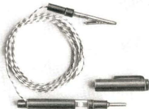
Bild 1 Die einzelnen Teile der Prüflampe
