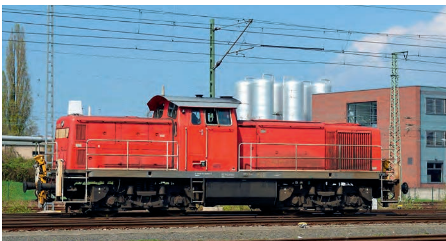
Oktober 2009: Im Rahmen eines Modernisierungsprogramms wird die 400. Lok der DB-Baureihe V 90 mit einem neuen MTU-Motor versehen (hier 294 895 in Dresden-Altstadt, April 2017).
