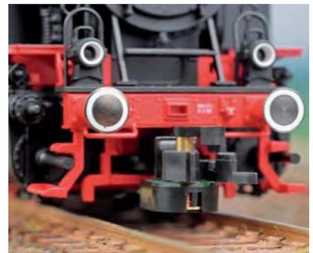
Die Kupplungen vorne und hinten werden über die Funktionstasten F1 u. F2 bedient. Nach etwa 1,5 Sekunden schaltet die Momentfunktion des Decoders ab und der betätigte Riegel fällt wieder nach unten.
