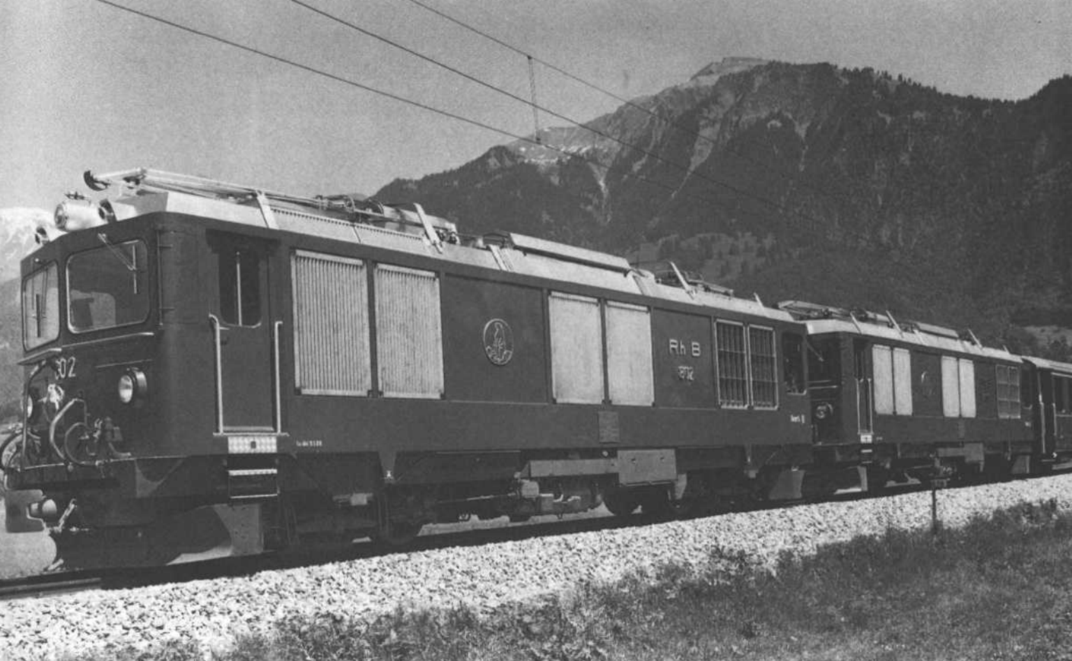
Bild 1: Zweikraft-Lokomotiven der Reihe Gem 4/4 Nr. 802 und 801 in Doppeltraktion. Wie aus den eingezogenen Pantographen ersichtlich ist, fahren die Loks hier dieselgetrieben.
