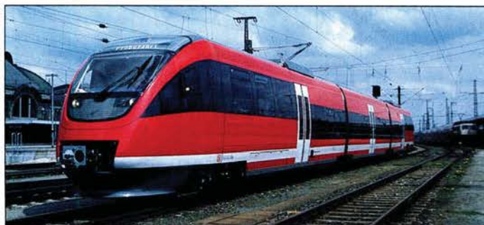
Die ersten beiden dieselhydraulischen Talent-Triebwagen erprobte die Deutsche Bahn AG Ende April 1999 im Raum Schwandorf. 643 002 wartete am 24. April 1999 auf die Rückfahrt zum Herstellerwerk in Aachen.
