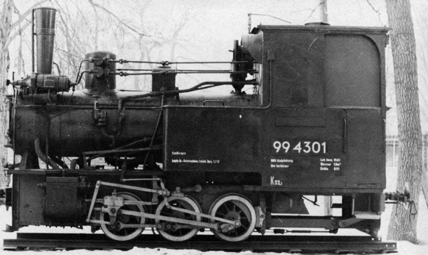
Bild 1: Die großen Überhänge vorn und hinten, der geringe Kuppelraddurchmesser von 600 mm und die bescheidene Bremsausrüstung erklären die auf 15 km/h festgesetzte Höchstgeschwindigkeit. Die Züge zum Dampfdom auf der Heizerseite sind mit Kardangelen versehen.
