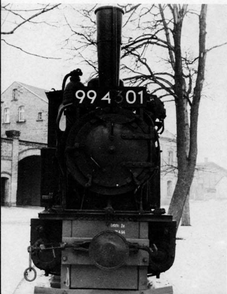
Bild 2: In dieser Frontansicht wird die Gesamtbreite von nur 1600 mm glaubhaft. Am Schornstein wird in einem gesonderten Rohr der Lichtmaschinenabampf abgeleitet.
