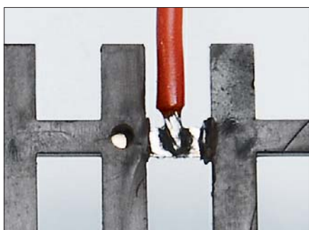
Angelötetes Kabel an der Profilunterseite am RocoLine-Gleis
