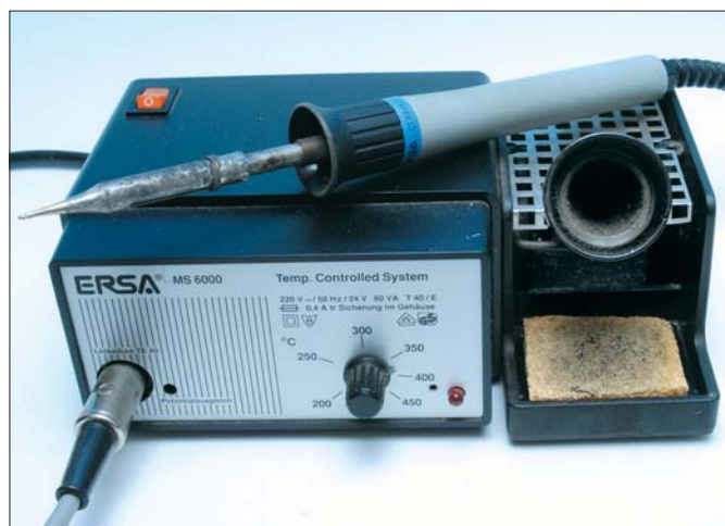
Analoge Lötstation mit elektronischer Temperaturregelung, Ablageständer, Schwammbehälter und auswechselbarer Lötspitze.
