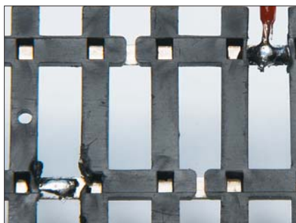
Verzinnnte Lötstelle unten am Roco-N-Gleis und angelötetes Kabel oben
