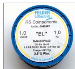
Zwei unterschiedliche 1-mm-Lote mit dem gleichen Flussmittelanteil. Das bleifreie Lot oben erfordert eine höhere Löttemperatur im Gegensatz zum bleihaltigen Lot unten.
