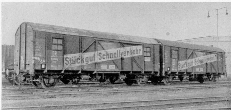
Aus zwei kurzgekuppelten und mit Faltenbälgen verbundenen Großraum-Güterwagen G1mhs Leipzig wird eine „Leig-Einheit“ für den Stückgutschnellverkehr mit dem nunmehrigen Gattungszeichen G1lmhs.
