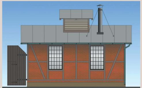
Zu den kleinsten Lokschuppen überhaupt dürften die von der Kleinbahnbau- und Betriebsfirma Lenz aus Stettin entworfenen, eingleisigen, einständigen Lokschuppen für schmalspurige Lokomotiven von 600 bis 1000 mm Spurweite gehören. Diese Lokschuppen traten örtlich in zwar unterschiedlichen Bauweisen und Bauformen auf, doch war allen eine Grundgestalt eigen, die Uwe Volkholz in seiner zeichnerischen Rekonstruktion zusammengefasst hat. Links eine Seitenansicht, unten Front- und Rückansicht.
