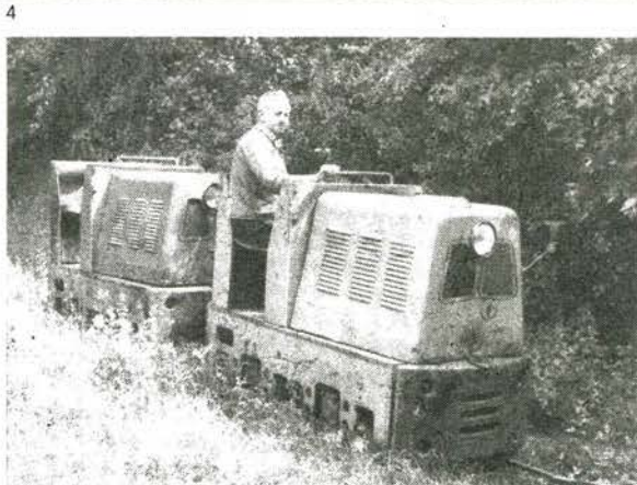
3 Lokomotive der Baureihe Ns 4 des VEB GISAG Schmiedeberg (LKM/250027/1957), Spurweite 750 mm, aufgenommen am 7. April 1987
