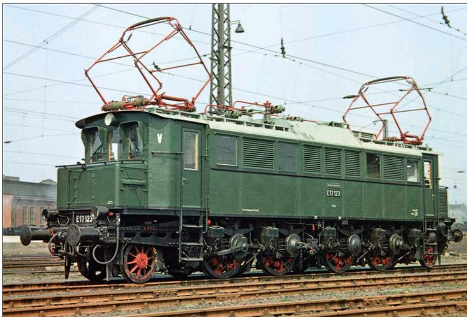
**16** Beim Bau der E 17 ging man mit dem Einzelratsatzantrieb neue Wege – Bernd Zöllner beschreibt den konstruktiven Werdegang dieser Maschine, deren Antrieb wegweisend war. Außerdem hat er das aktuelle Modell dieser Baureihe von Piko – die Sonneberger realisieren eine modernisierte Ausführung – eingehend getestet. *Foto: Sammlung Bernd Zöllner*
