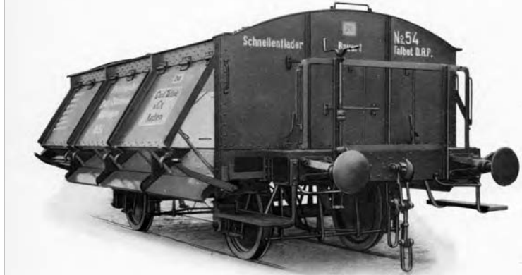
Der Wagen 54 der Stahlwerke Völklingen besaß ebenfalls einen flachen Boden, der sich beim Entladen aufstellte – auch dieses System hatte sich Talbot patentieren lassen.
