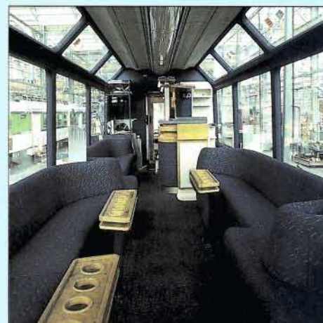
Bilder 5 bis 9: Ein neues Reisegefühl für das nächste Jahrhundert vermittelt heute bereits der elegante Crystal-Panoramic-Express. Die Werkaufnahmen zeigen den in Italien gebauten Crystal-Steuerwagen mit dem verglasten Aussichtsoberteil, der komfortablen Salonbar und dem erhöhten Lokführerstand.
