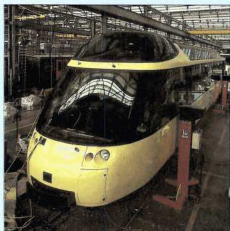
Bilder 5 bis 9: Ein neues Reisegefühl für das nächste Jahrhundert vermittelt heute bereits der elegante Crystal-Panoramic-Express. Die Werkaufnahmen zeigen den in Italien gebauten Crystal-Steuerwagen mit dem verglasten Aussichtsoberteil, der komfortablen Salonbar und dem erhöhten Lokführerstand.
