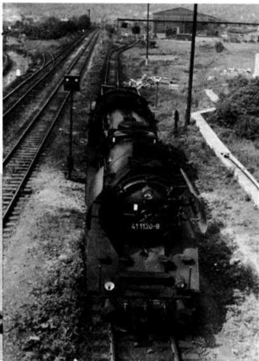
Bild 6 zeigt zum Vergleich die Baureihe 41 der DDR. Auch in der DDR erhielt die Baureihe 41 einen Neubaueessel und wird deswegen als Reko (Rekonstruktions) Lokomotive bezeichnet. Der eigenartige Oberflächenvorwärmer ist nur in der DDR anzutreffen.
