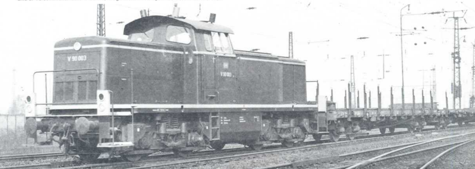
Bild 2: Vorserienlokomotive V 90003, ausgerüstet mit Rangierfunk und Fernsteuerung.
