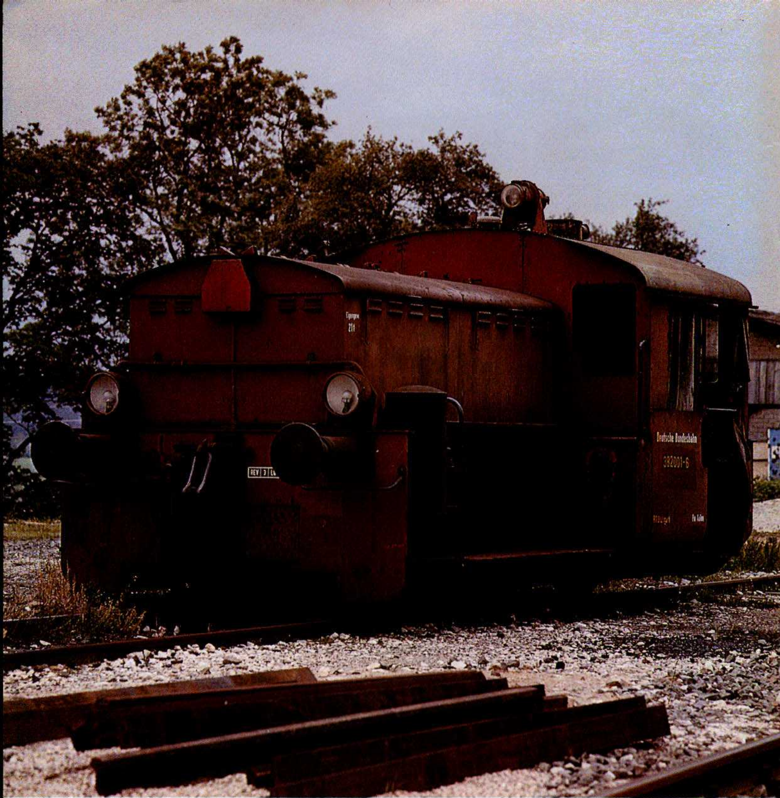
Bild 1: Im Jahr 1955 stellte die DB zwei neue Akkulokomotiven in Dienst, die in ihren Hauptabmessungen der Köf II entsprachen. Die Aufnahme zeigt die Lok 382 001 in Bopfingen. Farbfoto: H. Obermayer
