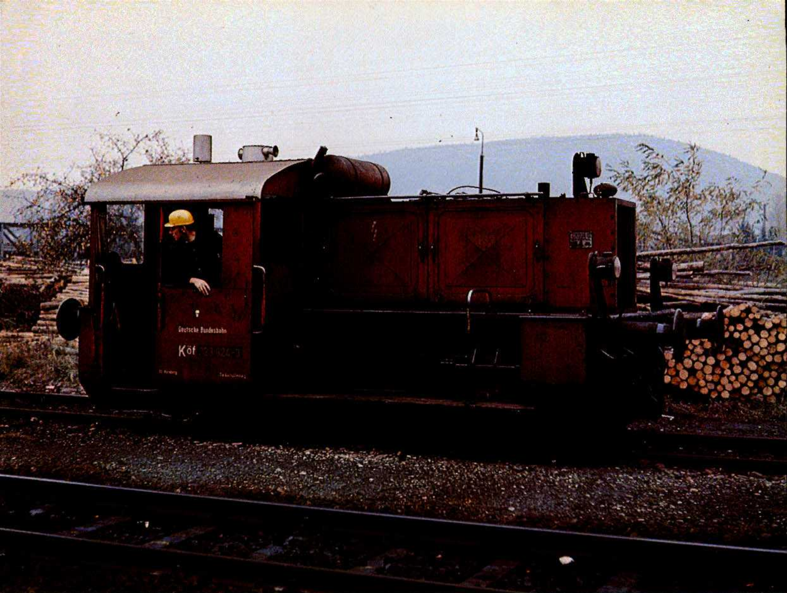
Bild 2: Eine der Kleinlokomotiven der Leistungsklasse II in Standardausführung mit hydraulischer Kraftübertragung, aufgenommen im Bahnhof Miltenberg.
