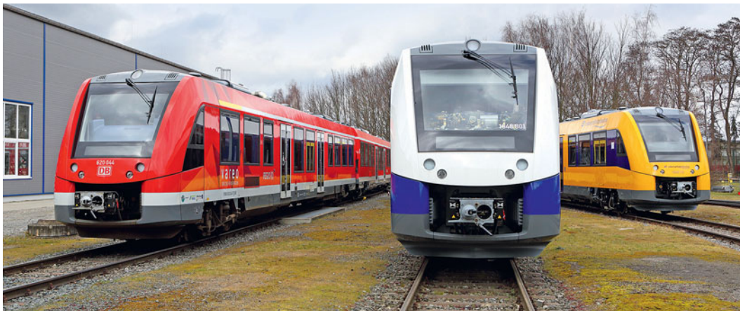
Neue LINT-Triebzüge warten auf ihre neuen Eigentümer: Das Bild zeigt links den dreiteiligen 620 044/621 044/621 544 für DB Regio, der durch Einfügen eines neuen Mittelwagens aus einem zweiteiligen 622 entstand. In der Mitte der zweiteilige 1648 801/1648 301 für die LNVG sowie rechts der ebenfalls zweiteilige 1648 710/1648 210 für die Oberpfalzbahn im Alstom-Werk Salzgitter am 23. März 2016. FOTO: JÜRGEN HÖRSTEL
