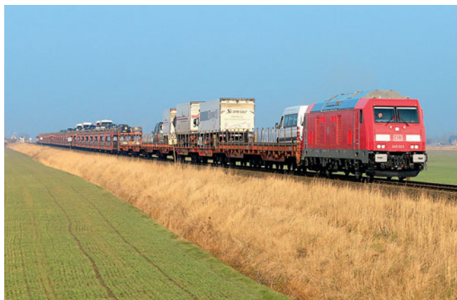
Die roten DB-245 mit vier Dieselmotoren werden nun zum gewohnten Bild beim SyltShuttle: 245 023 am 9. März 2016 bei Niebüll. FOTO: AXEL WITZKE
