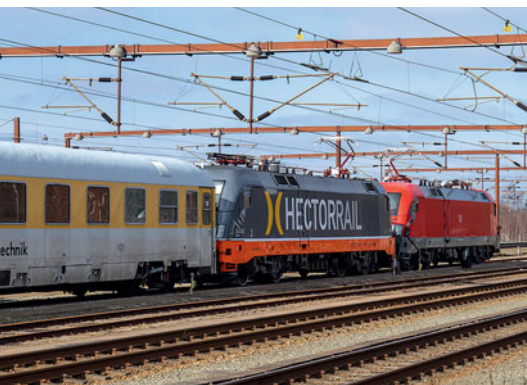
In der letzten Märzwoche stellte der Messzug einen Rekord von 235,8 km/h auf dem dänischen Eisenbahnnetz auf. Da die Taurus-Lokomotiven des Messzuges keine Zulassung für Dänemark hatten, mussten zusätzliche Messungen die elektromagnetische Verträglichkeit nachweisen. FOTO: DB
