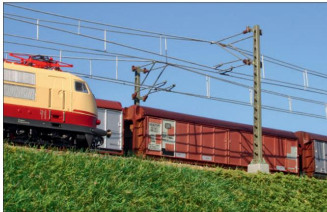
Radspanwerke können auch im Modell nachgebildet werden, hier das H0-Modell von Viessmann. Fahrdrabt und Trageil sind separat nachgespannt. Zur Nachbildung einer vorbildgerechten Überlappung an den Nachspannungen müssen Masten mit Doppelausleger aufgestellt werden. Sie stammen hier ebenfalls von Viessmann.
