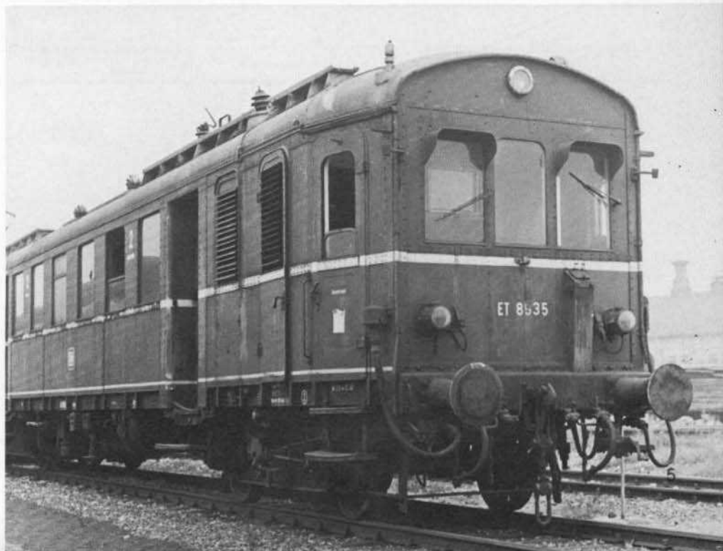
Bild 2: Dieser ET 85 35 der letzten Lieferserie hatte weder Fronttüren noch eine Übergangeinrichtung. Foto: HJO
