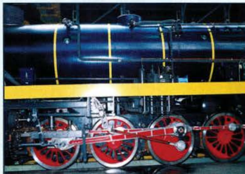
Die SLM Winterthur rüstete die Dampflokomotive mit modernen, wartungsarmen Rollenlagern aus.
