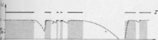
Abb. 3. Aus diesem Spannungs-Zeit-Diagramm kann man deutlich die verbesserte Stromversorgung der Lämpchen nach dem Überbrücken mit einem Kondensator ersehen. Die gerasterten Flächen sollen die Höhe der Spannung an der Lampe (ohne Elko) verdeutlichen (Schwankung zwischen 0 und - dem angenommenen Wert - 1). Die gepunktete Linie läßt erkennen, daß durch den Kondensator (vor allem bei den häufig vorkommenden kurzen Unterbrechungen) die Spannung ziemlich konstant gehalten wird. Die Linie bei Z kennzeichnet die Zeiten des einwandfreien Kontaktes.
