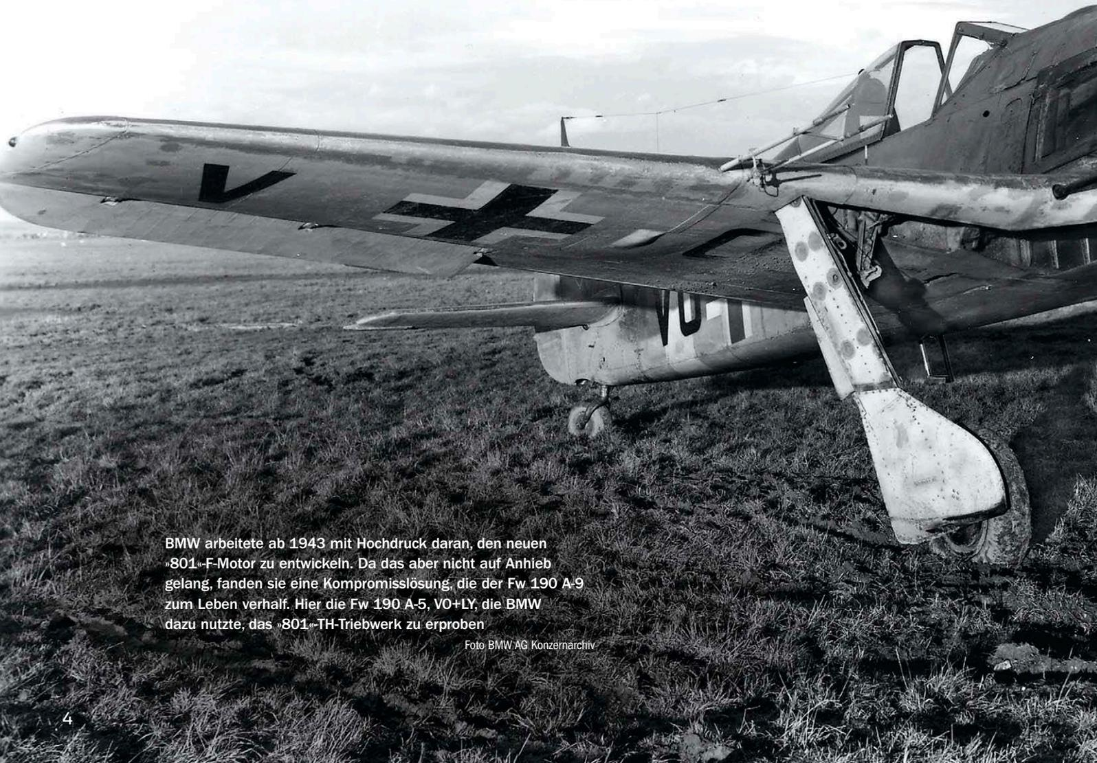
BMW arbeitete ab 1943 mit Hochdruck daran, den neuen »801«-F-Motor zu entwickeln. Da das aber nicht auf Anhieb gelang, fanden sie eine Kompromisslösung, die der Fw 190 A-9 zum Leben verhalf. Hier die Fw 190 A-5, VO+LY, die BMW dazu nutzte, das »801«-TH-Triebwerk zu erproben
