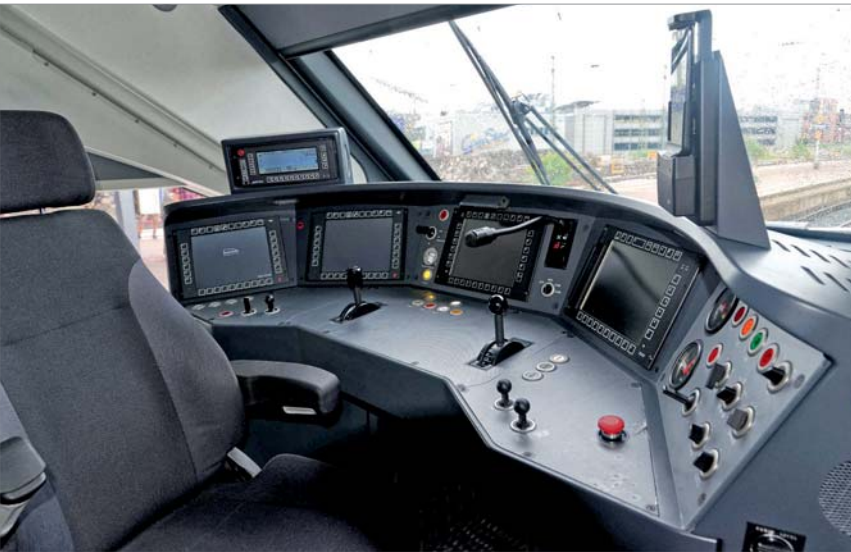
Bildschirme prägen den Arbeitsplatz im Link des polnischen Herstellers Pojazdy Szynowe Pesa Bydgoszcz SA/Pesa (deutsch: Schienenfahrzeuge Bromberg AG).
