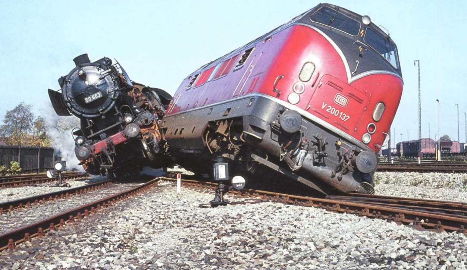
Bild 10: Am 17. Oktober 1965 stießen im Bereich des Bw Buchloe die 50 663 und die V 200 137 zusammen, Aufgrund eines mißverstandenen Befehls eines Feuermanns setzten sich beide Loks gleichzeitig in Bewegung, fuhren auf der Weiche ineinander und hebelten sich gegenseitig in die Höhe. Foto: F. Nißel
