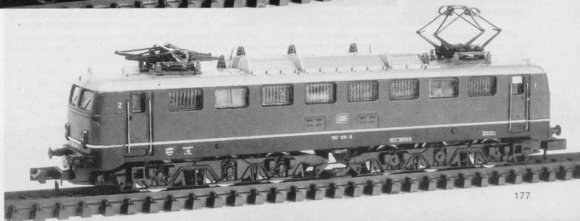
N Abb. 16. Die schwere 6achsige Neubau-Ellok der DB, die E 50, erhält noch silber eingefärbte Lüfterblenden.
