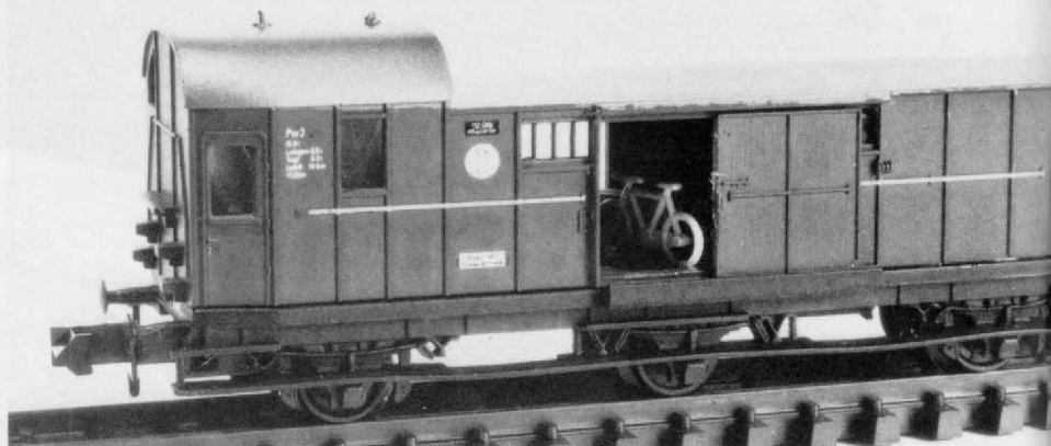
N Abb. 19. Die Arnold-78 bekommt eine Schwester – womit den N-Bahnern dann nach jahrelangem „Darben“ drei 78-Versionen zur Verfügung stehen! Augenfälligstes Unterscheidungsmerkmal ist der Lüftungsaufsatz auf dem Dach (rechts zum Vergleich die bisherige Ausführung mit dem runden Dach).
