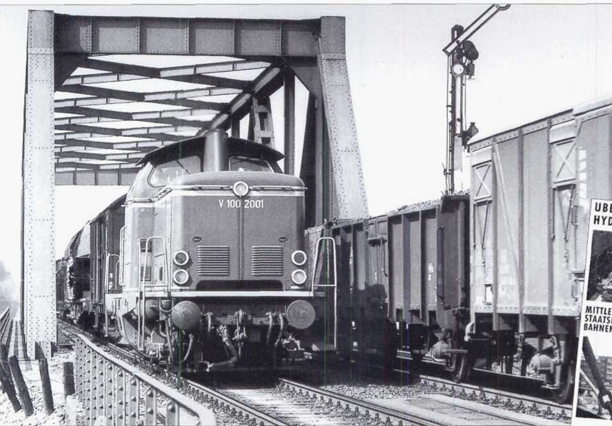
V 100 006 wurde Ende 1959 an den Hersteller MaK zurückgegeben, mit einem 1350-PS-Motor ausgerüstet und dann als V 100 2001 in der BD Münster erprobt – hier aufgenommen im März 1964 auf der Kanalbrücke in Hiltrup. Abb.: Ludwig Rothowe
