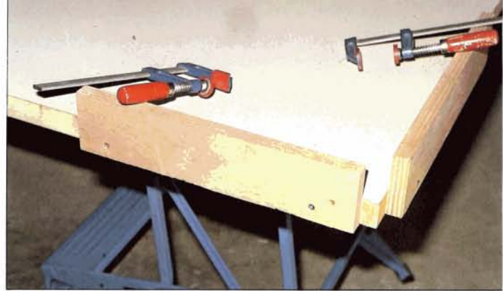
Bild 9: Um die Rahmenteile exakt rechteckig aneinanderfügen zu können, werden zwei Anschlagbretter angeschraubt.
