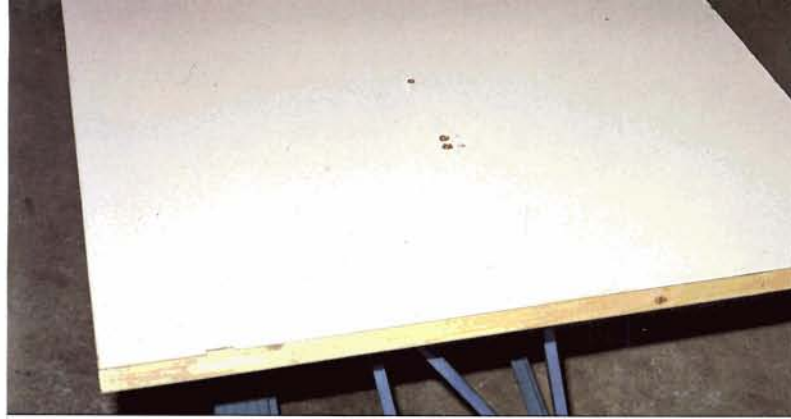
Bild 8: Ein halbes Türblatt oder eine ähnlich glatte und rechteckige Platte dient als Werkbank für den Zusammenbau der Rahmenteile.
