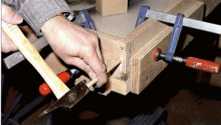
Bild 15: Dann wird etwas Kaltleim in das Bohrloch gegeben und der Dübel eingeschlagen.
