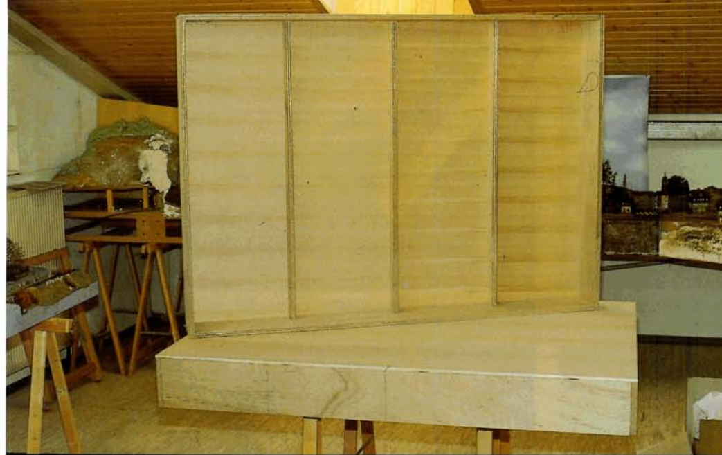
Bild 18: Zwei aufeinandergestellte Rahmen-teile. Gut zu erkennen: die Zwischenstreben.
