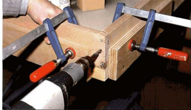
Bild 14: Anschließend bohrt man Löcher für die Holzdübel. Sie sollten der Stabilität wegen nicht schwächer als 8 mm sein.
