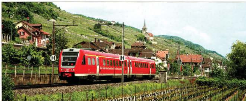
DBAG-Messzug in der Schweiz: Vom 15. bis 27. Mai 2008 weilte ein VT612 in der Schweiz, wo zusammen mit SBB-Messtechnik diverse Fahrten durchgeführt wurden. An vier Tagen war der 612 901-0, Versuchsträger für Fahr- und Schwingungstechnik der DBAG, Prüfstation Minden, zwischen Biel und Lausanne anzutreffen. Vom 22. bis 25. Mai 2008 neigte sich der VT zwischen Erstfeld und Göschenen durch die Kurven der Nordrampe des Gotthards. Am 16. Mai 2008 befand er sich bei Schafis am Bielersee auf der Fahrt von Biel nach Lausanne.
