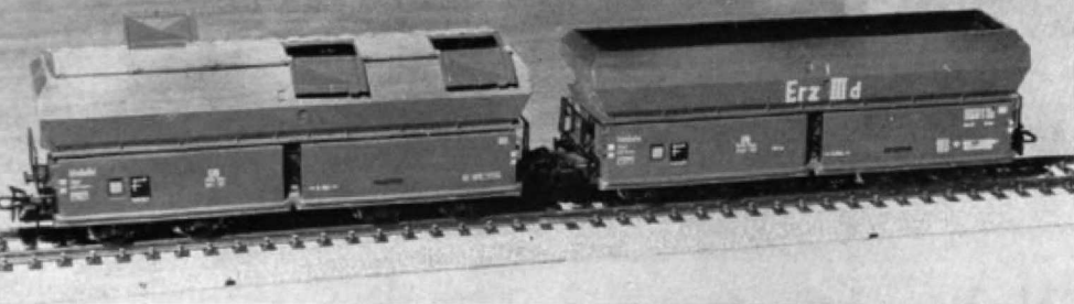
Abb. 142. Der KkT 57 (links), ein besonders wirkungsvoller Wagentyp, wird beim Vorbild vorwiegend zur Beförderung witterungsempfindlicher Schüttgüter eingesetzt, der OQtz 50 (rechts) dagegen für unempfindliche (wie Kohle, Erz usw.). Man beachte die feine Modellbeschriftung! Lüp der Wagen je 13,3 cm.
