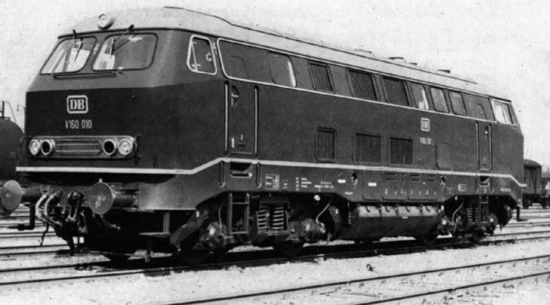
Abb. 1. Der „Lollo-Busen“ ist weg, wenigstens bei der Serienausführung der V 160. Die nunmehr strengere Linienführung erhöht zweifellos den Gesamteindruck. Im übrigen sind die Abmessungen im wesentlichen etwa die gleichen geblieben wie bei den Probeausführungen. (Foto: DB/Engels)
